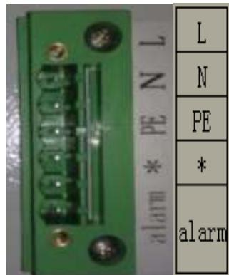
Фиксированная часть терминала
