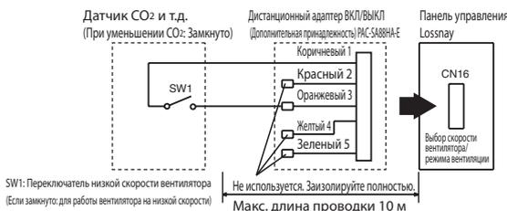
Если переключатель SW1 находится в положении "ВКЛ", скорость вентилятора Lossnay будет установлена в положение "Низкий" независимо от настройки пульта дистанционного управления. Используйте его таким образом, чтобы он обеспечивал вентиляцию при Высокой скорости вентилятора обычным образом, и когда внешний датчик обнаружит уменьшение загрязнения внутреннего воздуха, он переключается в режим Низкой скорости вентилятора.
