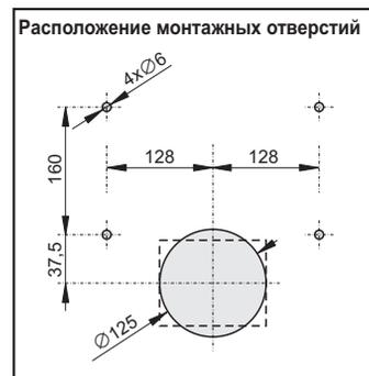
Единица подвешивается на опорную анкерную плиту, которая прикрепляется с помощью шурупов и шпонок на стену. На расстоянии 100 мм от корпуса установки и 500 мм от впускного патрубка установки или трубопровода не должны находиться горючие массы.
