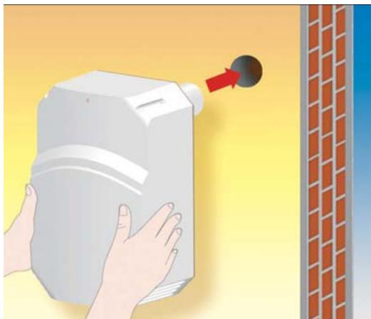
Приточный воздух будет проходить через внутренний воздуховод  $\varnothing$  63 мм (в комплекте, длина 400 мм), а вытяжной воздух – между внутренним и наружным.
